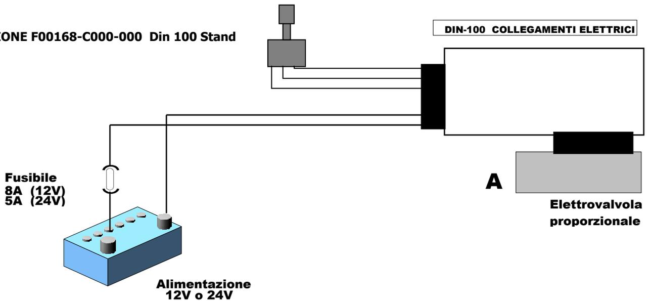
**INSTALLAZIONE F00168-CP0N-000 Din 100 con Ingresso ad impulsi con Step da 10mA a 50mA**
